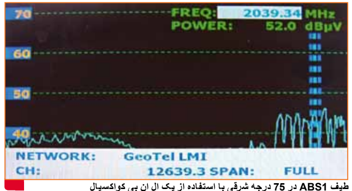
طیف ABS1 در 75 درجه شرقی با استفاده از یک ال ان بی کوآکسیال
