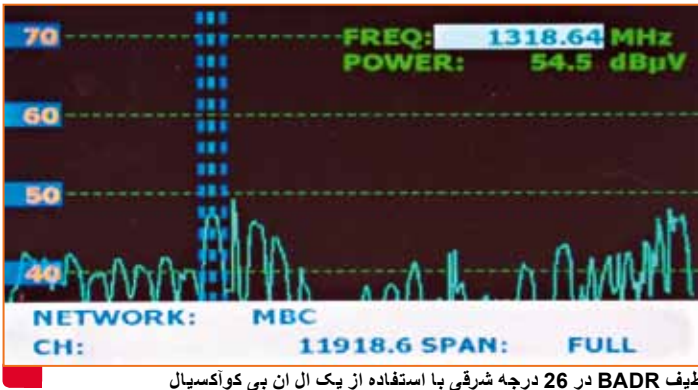
طیف BADR در 26 درجه شرقی با استفاده از یک ال ان بی کوآکسیال
