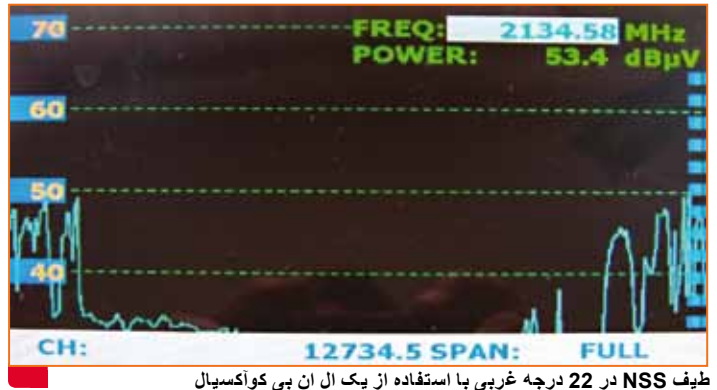
طیف NSS در 22 درجه غربی با استفاده از یک ال ان بی کوآکسیال
